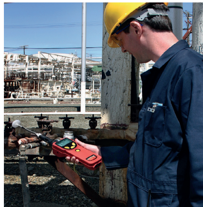
Os operadores podem obter leituras de COV de forma fácil e rápida em qualquer local das instalações com o UltraRAE 3000+ dos Sistemas RAE
